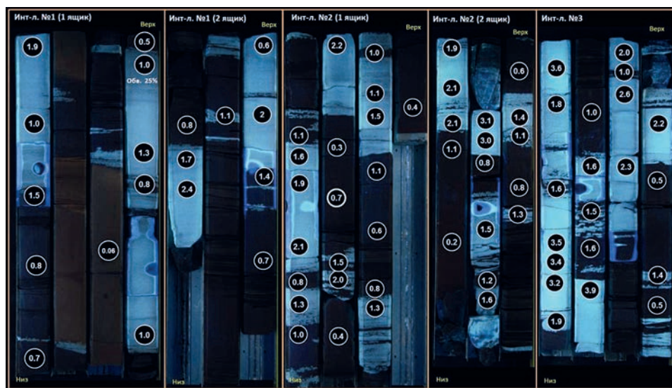
Рис. 5.10. Распределение величин коэффициентов абсолютной проницаемости по результатам лабораторных определений на стандартных образцах керна, с местом отбора образцов и интенсивностью свечения керна в ультрафиолетовом свете
