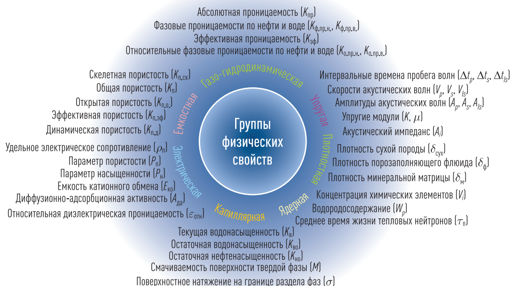
Рис. 1.1. Соотношение групп физических свойств и определяющих их основных петрофизических характеристик нефтяных коллекторов (по В. Н. Кобрановой, 1986 [51])
