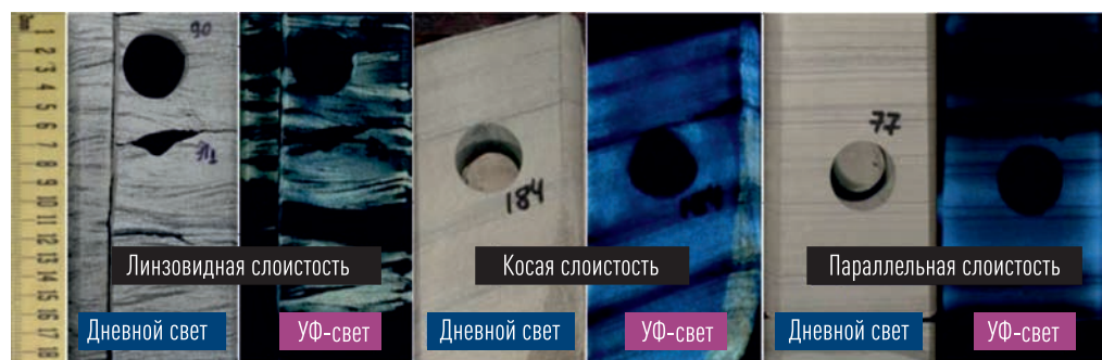
Рис. 2.7. Пример различных типов слоистости на полноразмерных образцах керна в дневном и ультрафиолетовом свете
