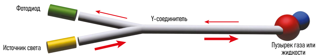
Рис. 7-20. Оптический путь пучка света GHOST.
