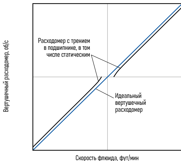
Рис. 4-4. Отклик вертушечного расходомера с трением, в том числе статическим.
