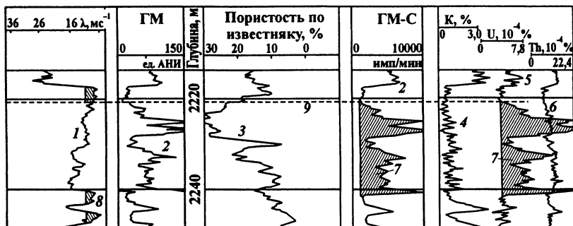
Рис. 64. Выделение обводненных и нефтенасыщенных интервалов и определение положения водонефтяного контакта в обсаженной скважине (Северная Америка) по данным импульсного нейтронного метода и спектрального гамма-метода.
