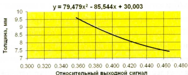
Рис. 3.38. Градуировочная характеристика канала толщиномера аппаратуры СГДТ-НВ при плотности 2 070 кг/м 3 вещества за колонной диаметром 146 мм
