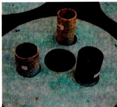
Рис. 3.10. Схема и фото комплекта трубных волноводов для аппаратуры акустического каротажа
