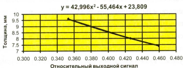
Рис. 3.37. Градуировочная характеристика канала толщиномера аппаратуры СГДТ-НВ при плотности 1 630 кг/м 3 вещества за колонной диаметром 146 мм
