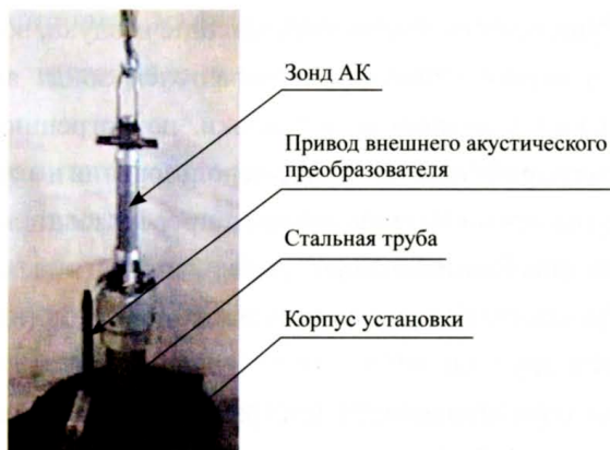
Рис. 3.12. Установка УПАК-2м со стальным волноводом
