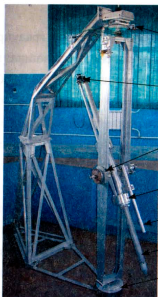
Рис. 3.44. Установка УАК-СИ для калибровки инклинометров
