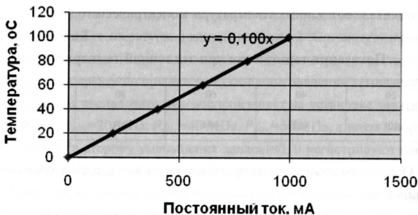
Рис. 5.9. График градуировочной характеристики канала температуры
