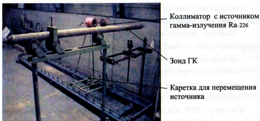
Рис. 5.2. Установка УПГК для калибровки аппаратуры гамма-каротажа
