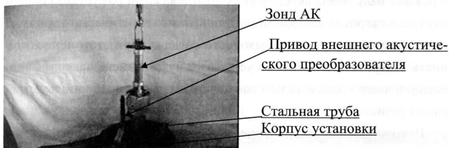
Рис. 2.9. Установка УПАК-2м со стальным волноводом
