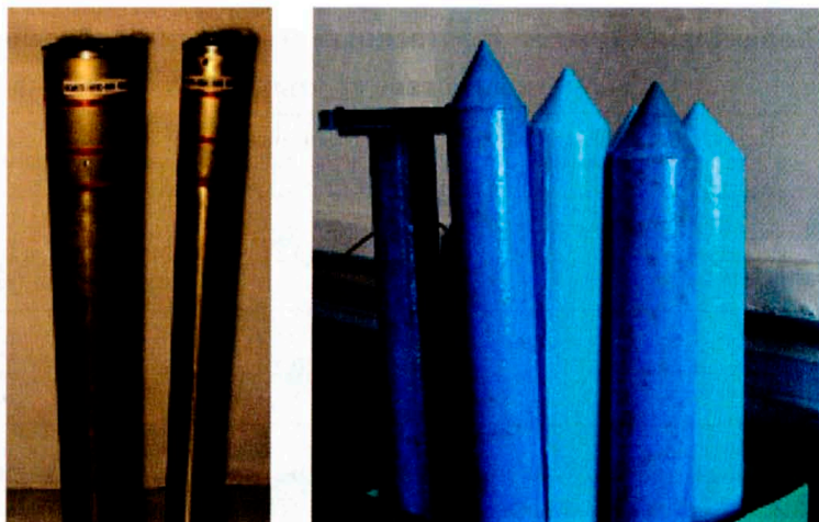
Рис. 3.18. Комплекты имитаторов пористости: а – КИП-НК-90 и КИП-НК-60; б – ИПП
