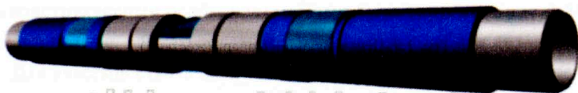
Рис. 1.11. Модульный отсекаТЕЛЬ пласта (внешний вид)
