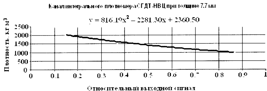
Рис. 3.14. Градуировочная характеристика канала плотнoмера аппаратуры СГДТ-НВ при номинальной толщине 7,7 мм колонны диаметром 146 мм
