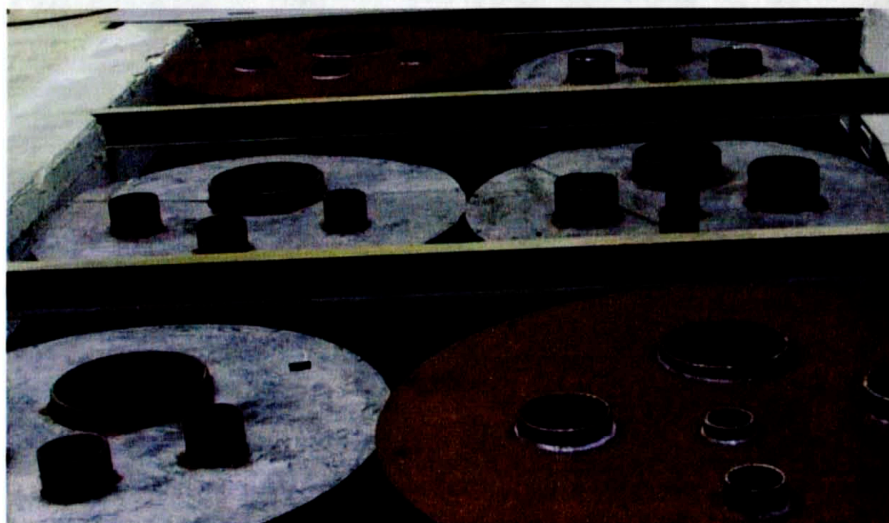
Рис. 3.7. Фото комплекта СО плотности вещества в затрубном пространстве колонн диаметром: 114; 146; 168; 178; 219; 245; 324; 430 мм
