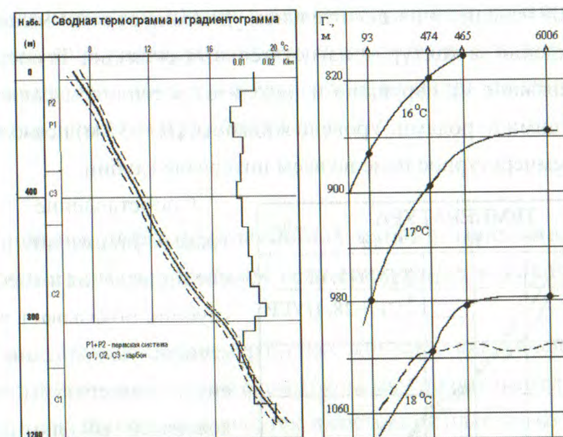
Рис. 3.1. Сводная геотермограмма и температурный профиль одного из месторождений Башкирии
