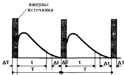
Рис. 3.10. Схема, поясняющая принцип измерения импульсными методами
