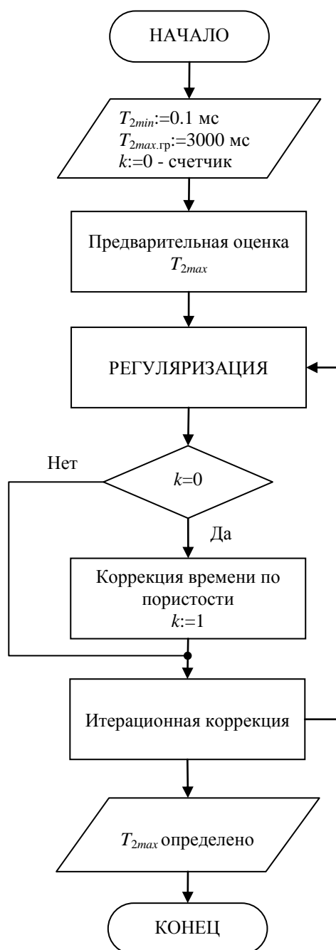
Рис. 1. Блок – схема алгоритма определения максимума спектра
